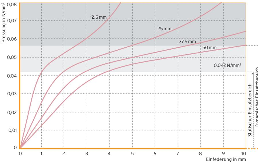
Abb. 1: Quasistatische Federkennlinie für verschiedene Lagerdicken
