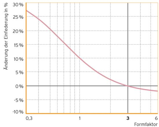
Abb. 6: Einfederung<sup>4</sup> in Abhängigkeit des Formfaktors
