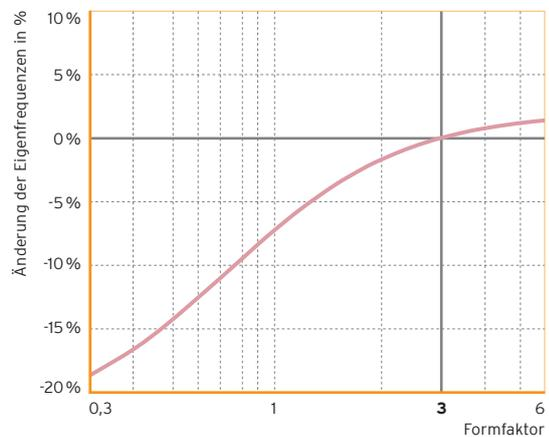
Abb. 8: Eigenfrequenz<sup>4</sup> in Abhängigkeit des Formfaktors
