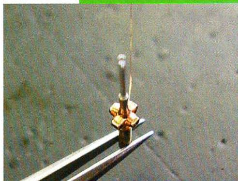
Ein fertig bestückter Nadelträger, bereit für den ebenfalls manuellen Generator-Zusammenbau.
